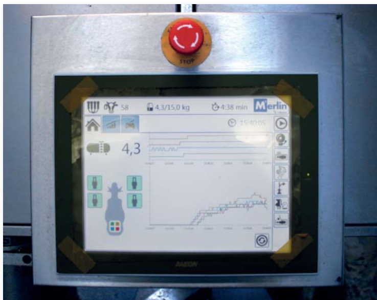
► Dotykový displej umístěný přímo na robotu umožňuje chovateli snadný přístup k údajům i ovládní robotu
